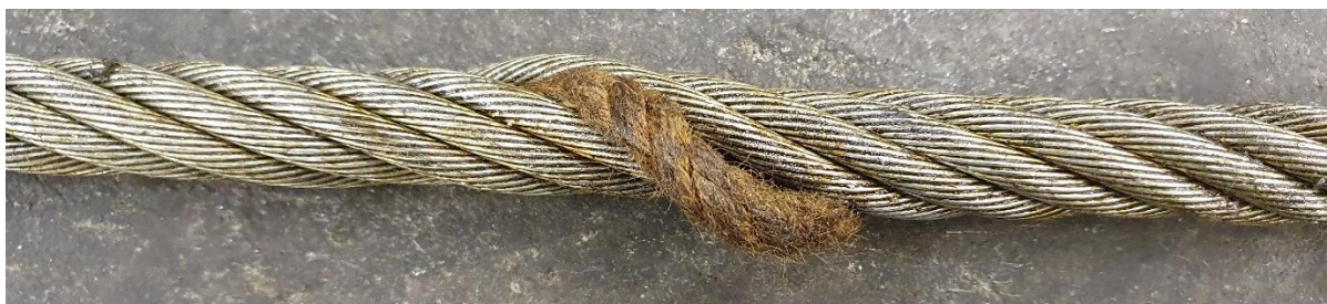
Ståltau hvor kjernen stikker ut
