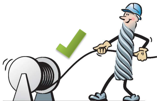
Ståltau på fritt roterende trommel
