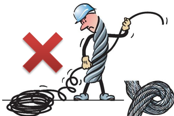
Ståltau løftet rett opp fra kveil
