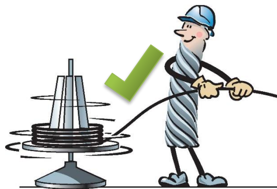
Ståltau på roterende bord
