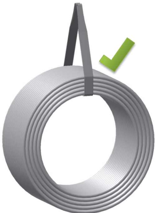
Kveil med ståltau løftet med båndstropp
