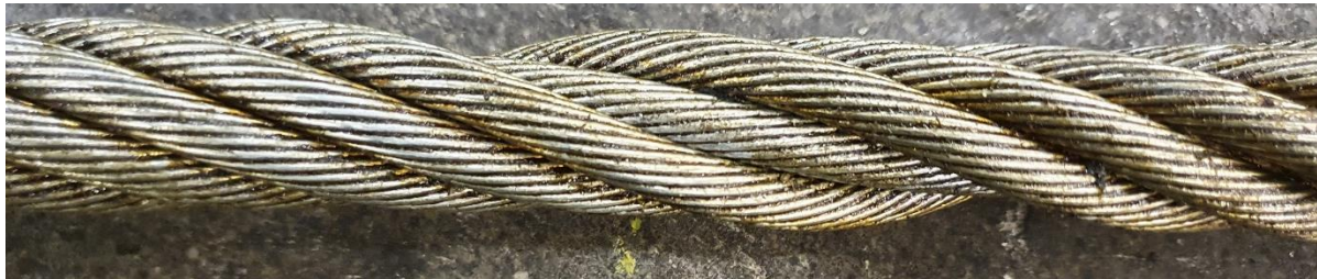
Ståltau med lokal reduksjon i diameter
