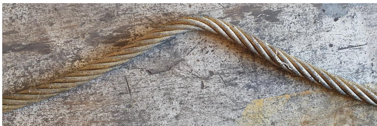
Ståltau etter løkken har blitt slått opp
