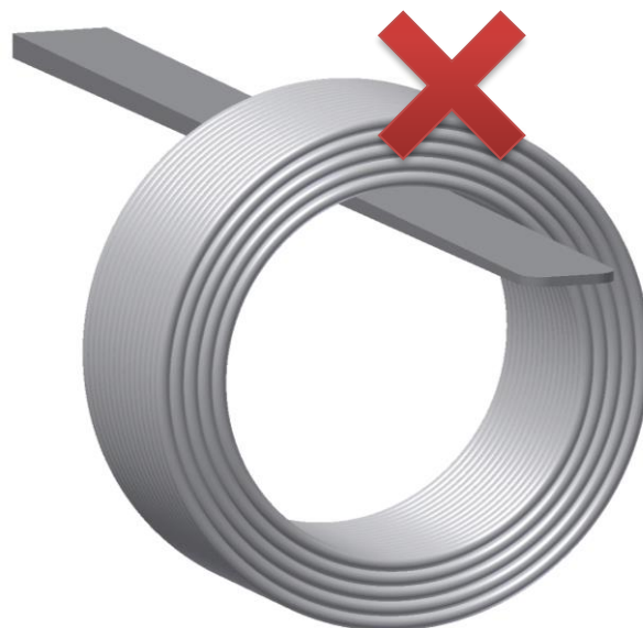
Kveil løftet direkte på truckgaffel
