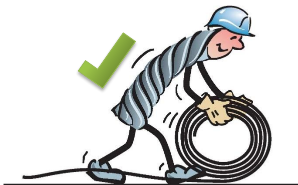
Kveil med ståltau som rulles ut
